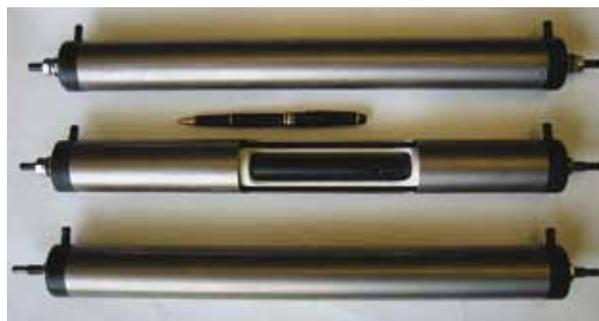
Рис. 1. Проточный электрохимический реактор
