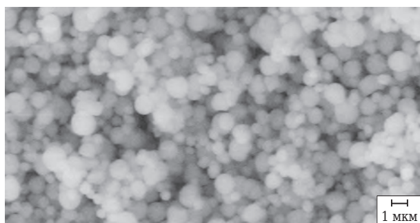
Рис. 2. Микрофотография порошка синтезированного карбоната кальция
