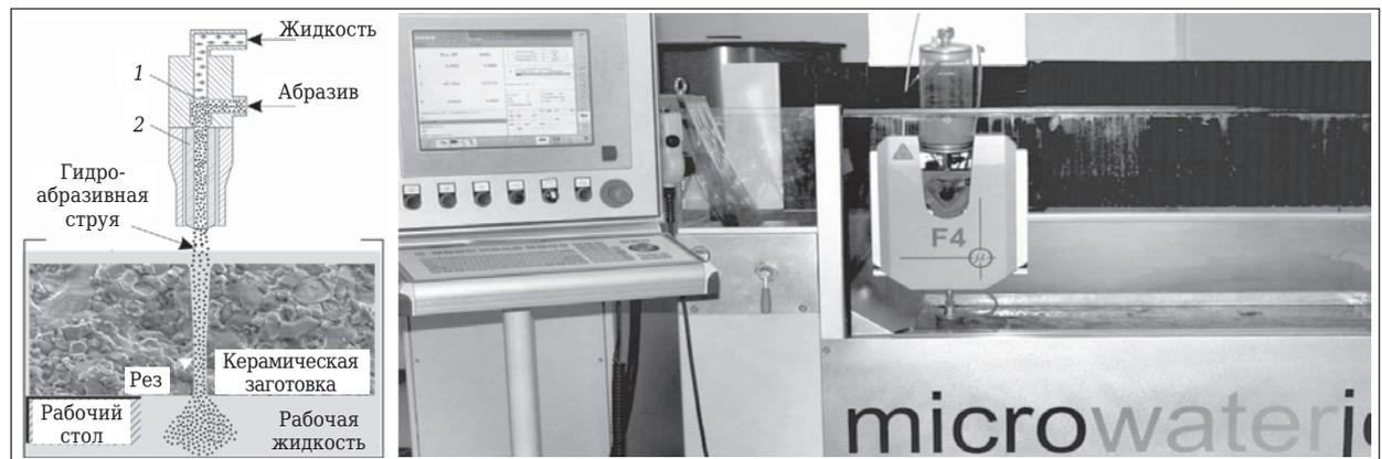
**Рис. 1.** Схема процесса гидроабразивного резания (слева) и общий вид технологической установки (справа)
