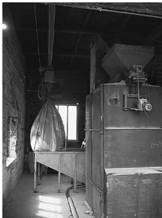
Рис. 6. Трехмодульная опытно-промышленная печь
