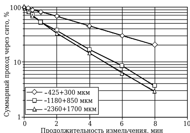
Рис. 4. Поведение материала при измельчении в шаровой мельнице
