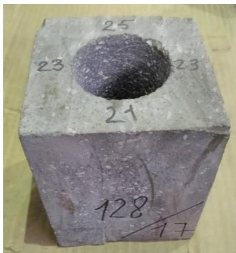
**Рис. 3.** Корундохромоксидный тигель до испытаний
